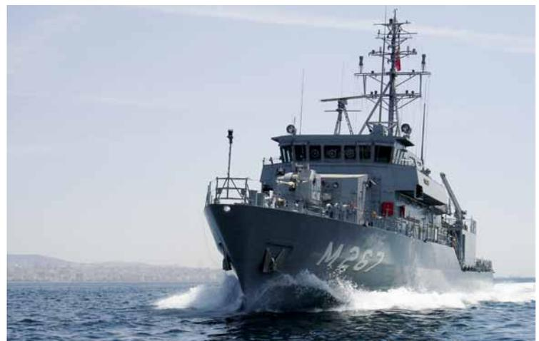
Minenjagdboote von Abeking & Rasmussen sind magnetisch neutral und so konstruiert, dass sie Minendetonationen widerstehen
