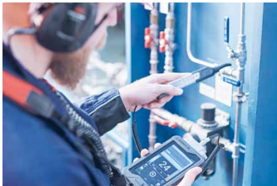
Mit dem SONAPHONE auf Lecksuche: Basierend auf Methoden der Strömungsakustik entwickelte SONOTEC ein weltweit neues Verfahren zur Klassifizierung und Bewertung von Leckagen an Druckluft-, Gas- und Vakuumanlagen
