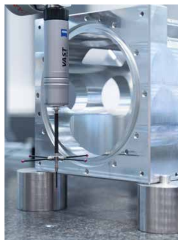
Hochpräzise Vermessung von Aluminiumkomponenten auf den µm genau
