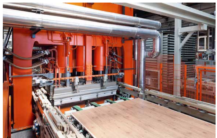
Das Kerngeschäft der Firma sind Kurztaktpressen-Anlagen zur Melamindirektbeschichtung von Holzwerkstoffen für die weltweite Möbel- und Laminatfußbodenindustrie
