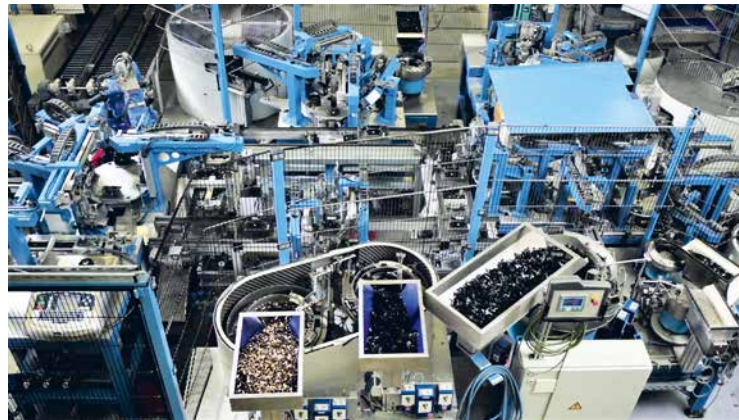
In der Produktion in Wustermark werden Ganzmetallumlenker für Sicherheitsgurte, weitere Sicherheitsbauteile fürs Auto sowie Abschirmbleche hergestellt
