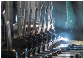
Schweißen von Schneefanggitterstützen
