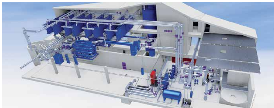
Das Konzept einer Wasserwiederaufbereitungsanlage, entwickelt mit CADISON
