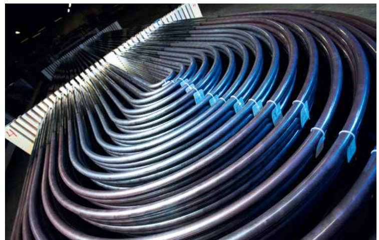
Nahtlose Rohre: In gerader Ausführung oder als U-Rohr (eigene Biegerei)
