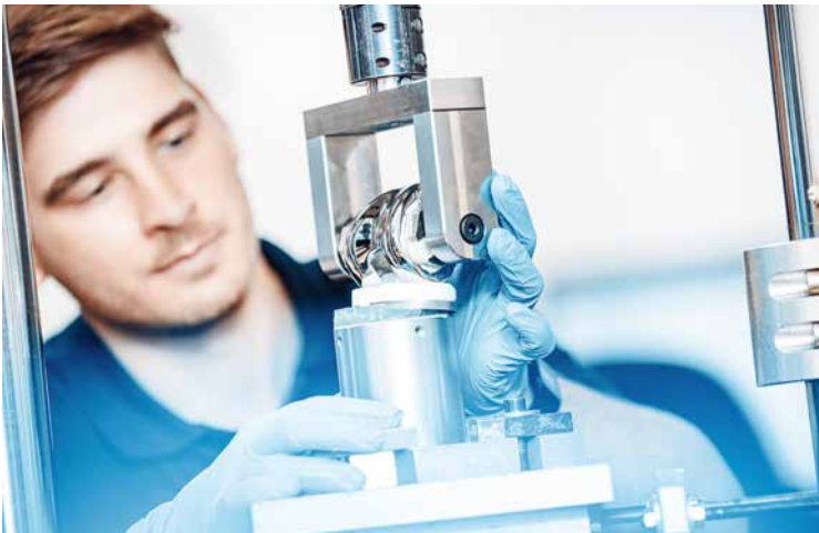
Qualität bedeutet Sicherheit - Ermüdungsprüfung an einem Knieimplantat mit einer Dauer von fünf Millionen Gesamtzyklen.
