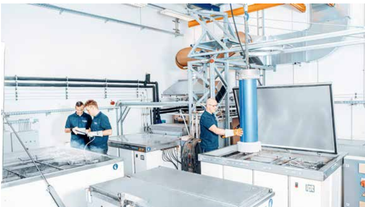
Bauprodukte wie beispielsweise Rohre müssen über Jahrzehnte stabil bleiben. Um das zu gewährleisten, werden sie einer Langzeitprüfung unterzogen.
