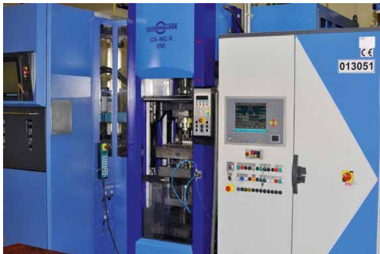
Pressautomat zum Pressen von Wendeschneidplatten für Zerspanungsanwendungen
