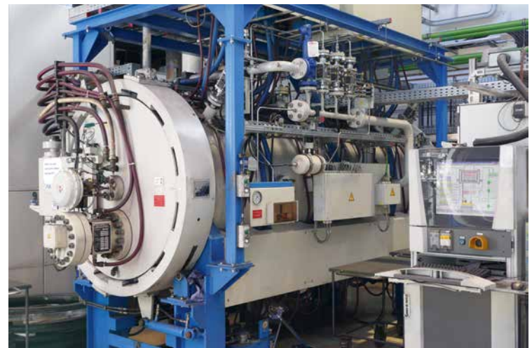
Sinterofen für die Herstellung der Hartmetall-Pulvermischungen
