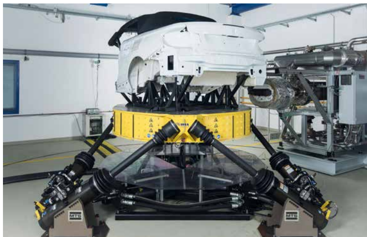
Bereich Automotive: Umweltsimulations-Prüfung an einem BMW Cabrio-Verdeck auf einem multi-axialen Schwingungstisch.
