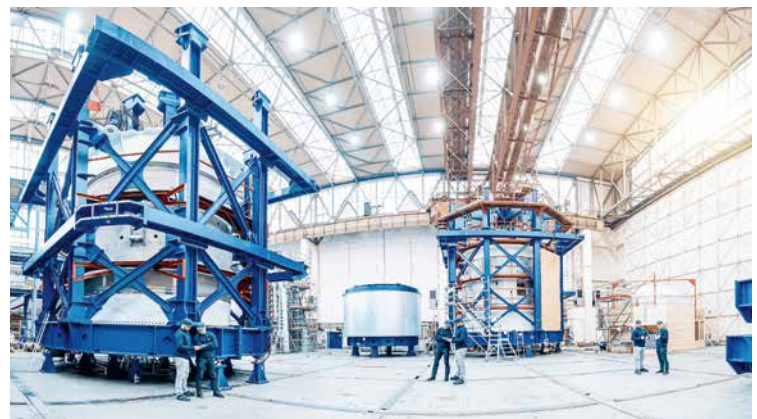
Bei der IMA Dresden hat der Bereich Luft- und Raumfahrt eine lange Tradition. Beeindruckend sind die Strukturprüfungen an Komponenten der Trägerrakete Ariane 5.
