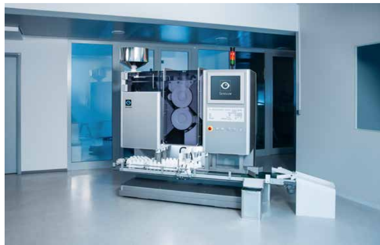
Einzigartig auf dem Markt: Sensums Spine Fibo vereint automatische visuelle Überprüfung, Zählen und Flaschenabfüllung von Tabletten, Kapseln und Softgelen
