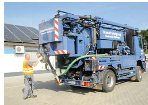
Mit dem Spülwagen wird die Kanalisation regelmäßig gespült
