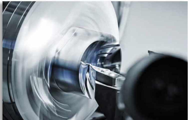
Mithilfe der ultrapräzisen Diamantbearbeitung werden Genauigkeiten im Nanometerbereich erzielt
