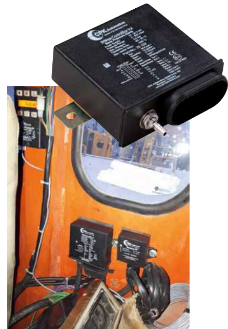
Datenerfassungssystem DYNTest, hier ergänzt um das Übertragungsmodul RemCo II
