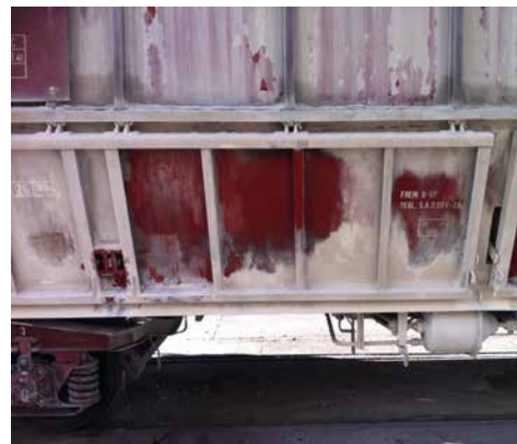
Der mit Kalk verdreckte Waggon bekommt durch die Trockeneisreinigung sein altes Gesicht zurück
