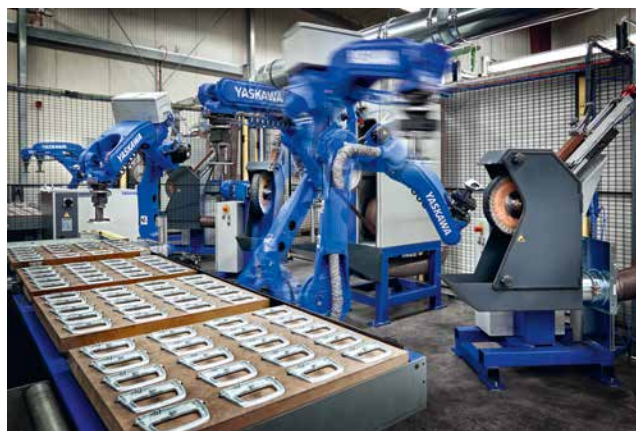
Durch Roboterbearbeitung beim Schleifen und Polieren kann das Unternehmen Prozesse optimal gestalten
