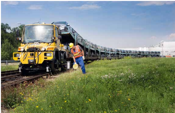
Rangieren per Funk – und ohne Lokführer: Die Steuersysteme EC/L02 und Freedom werden genau angepasst und lassen sich auch in bestehendes Material nachrüsten
