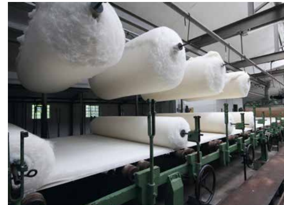
Wolle wird in mehreren Lagen verfilzt
