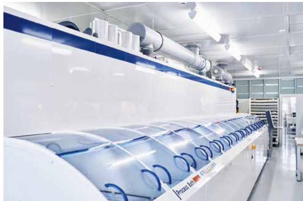
Mit den Produktionsanlagen und Fertigungslösungen für die nasschemische Verarbeitung von Solarzellen ist RENA Technologies ein Wegbereiter für erneuerbare Energien
