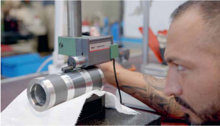
Messen eines Präzisionsbauteils
