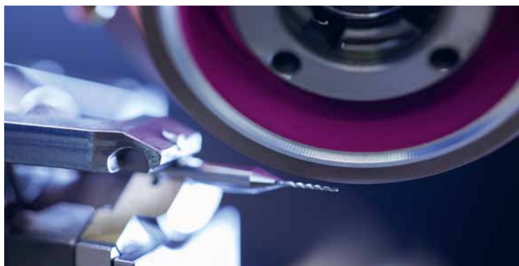
Produktion eines Hochleistungswerkzeugs für die Mikrozerspanung. Die Schleifprozesse für solche Werkzeuge sind extrem anspruchsvoll, der Korrekturbereich liegt bei 0.1 µm.
