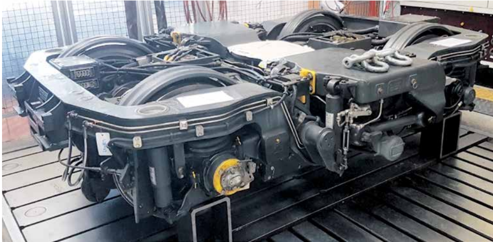
Untersuchung der Motorgetriebeeinheiten in eingebautem Zustand
