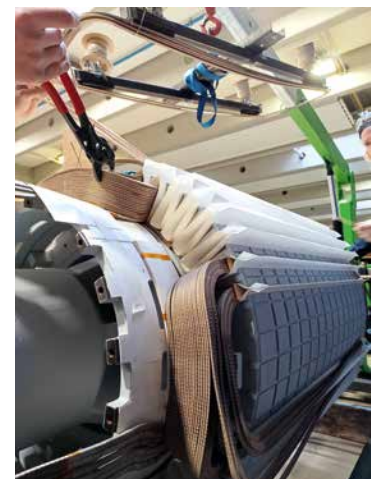
Eine Neuwicklung wird bearbeitet
