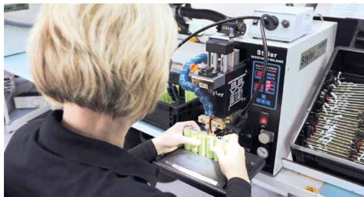
Blick in die Fertigung: Schweißen an einem Batteriepack
