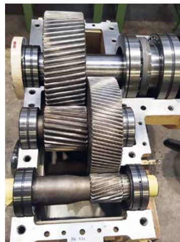
Ein revidiertes Stirnradgetriebe eines Extruders
