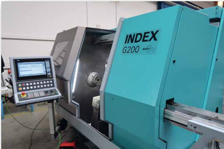
Alle Gebrauchsmaschinen werden mit dem Modernisierungsprogramm BOOSTTECH zu qualitativ hochwertigen Gebrauchsmaschinen umgebaut, wie zum Beispiel die Index G 200 Retrofit
