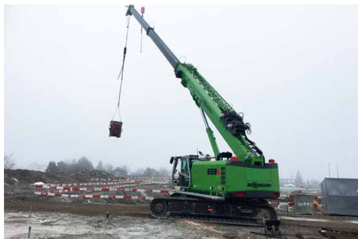
Teleskopkrane von Sennebogen mit Traglasten von bis zu 120 t sind auch unter Last voll teleskopierbar
