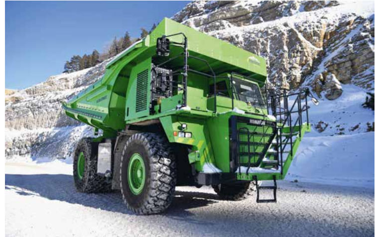
Der eDumper von Komatsu, das größte Elektrofahrzeug der Welt, erzeugt dank Rekuperation sogar Strom
