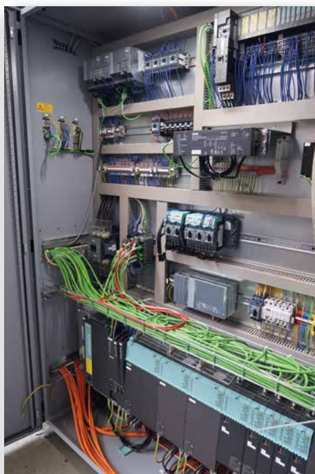
Auf dem neuesten Stand: Schaltschrank der Index G 200 Retrofit
