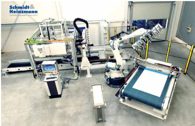
Eine Anlage im technischen Labor von Schmidt & Heinzmann zum Cutten, Stacken und Preformen
