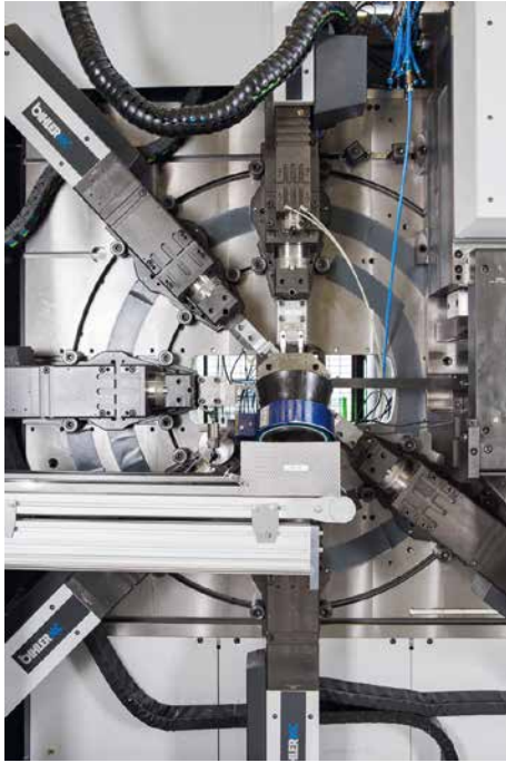
Moderne Produktion: Nebst Flachbettpressen werden auch Bihler-Automaten in der Fertigung eingesetzt
