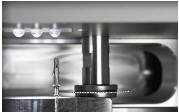
SawInspect System 6: kompaktes System für die Schlibfildanalyse sowie Inspektion von Crimpverbindungen und Abisolierungen
