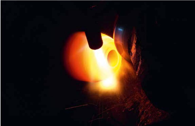
Flaschen werden aus einem Stahlblock und ohne Schweißnaht gefertigt
