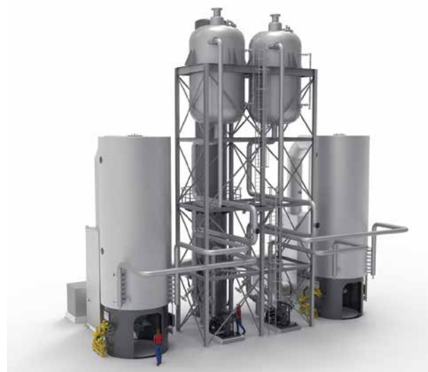
Ausgereiftes Know-how: Thermoöl-Anlage für die Produktion von PET-Flaschen
