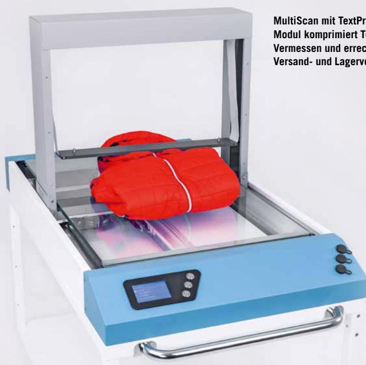
**MultiScan mit TextPress Modul: Das Modul komprimiert Textilien beim Vermessen und errechnet das korrekte Versand- und Lagervolumen**
