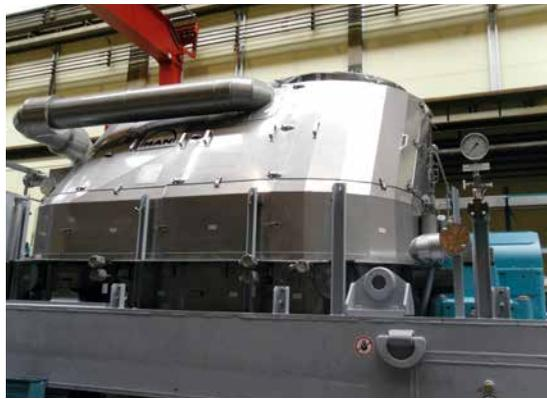
**Zwei auf einen Streich – Wärme- und Lärmdämmung**
