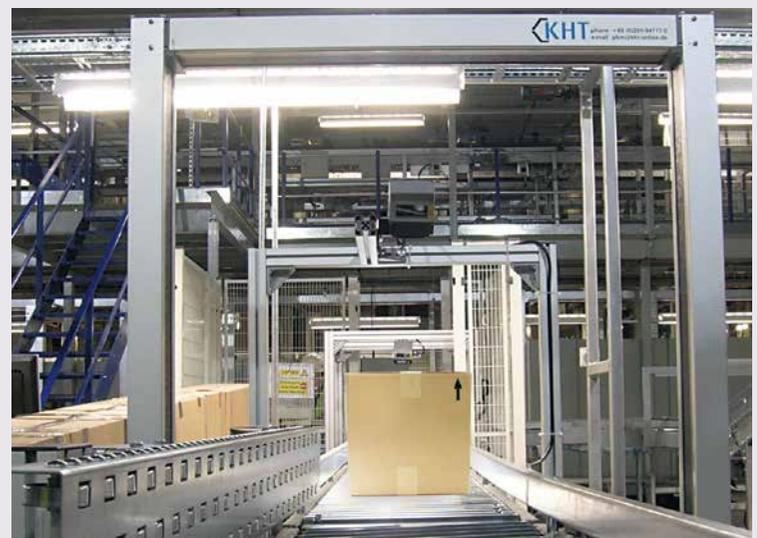
**KHT ProfileScan, der Messrahmen für Rollen- und Bandförderer: Er erkennt, kontrolliert und klassifiziert Produktprofile während des Durchlaufs**
